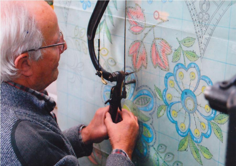
Thomas Hollenstein fährt an der Schiffstickmaschine mit dem Pantographen jeden Stich ab. (Foto: B.Hollenstein)
