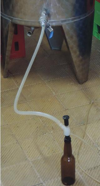
Ein einfaches Prinzip stellt sicher, dass jede Flasche gleich viel Bier enthält. Foto: MS
