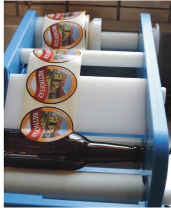
Alle Etiketten werden auf gleicher Höhe geklebt. Foto: MS
