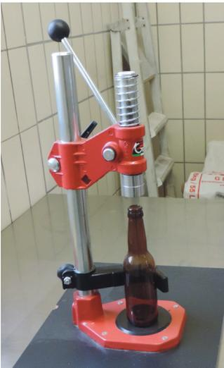
Das Gerät zum Verschliessen der Flaschen Foto: MS
